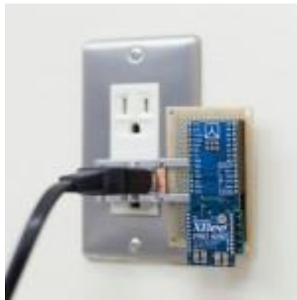
コンセントに装着した小型電力センサノード
