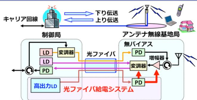
光ファイバ伝送路には波長の異なる上り信号、下り信号、給電光が多重されている。給電光は制御局（cs）に配備し、基地局（bs）で電気エネルギーに変換され、変調器（MOD）や増幅器（LNM）の駆動電源として使用する。
