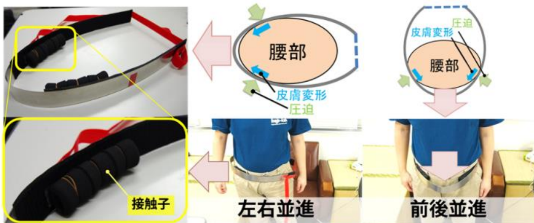
腰部ハンガー反射による並進力提示の様子
